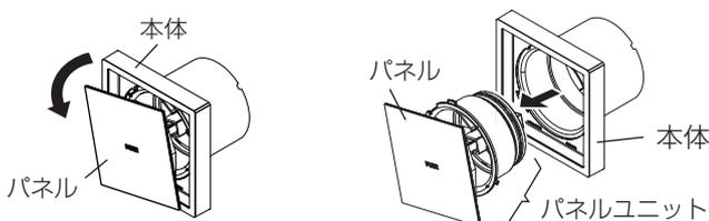
4. パネルユニットの凹部を本体の凸部に合わせて、必ず「カチッ」と音がするまでパネルを右に回転させて固定する。
