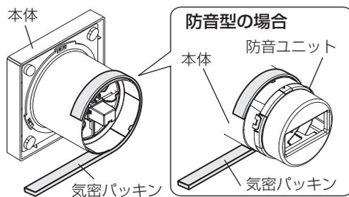
2. 下図の4か所または筒部に適量のシーリング材を塗布する。
