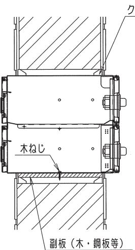
1. 取付開口底部に副板等を取り付け、水平レベルを出して下さい。
