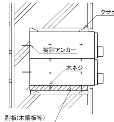
1. 取付開口部に副板等を取り付け、水平レベルを出してください。樹脂アンカーの打ち込み面は副板を固定するか、モルタル等で垂直レベルを出してください。
