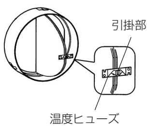
③取付け後、防火ダンパーが点検できる側に温度ヒューズが向くようにしてダクト内に押し込む。(バネにより固定されます)
